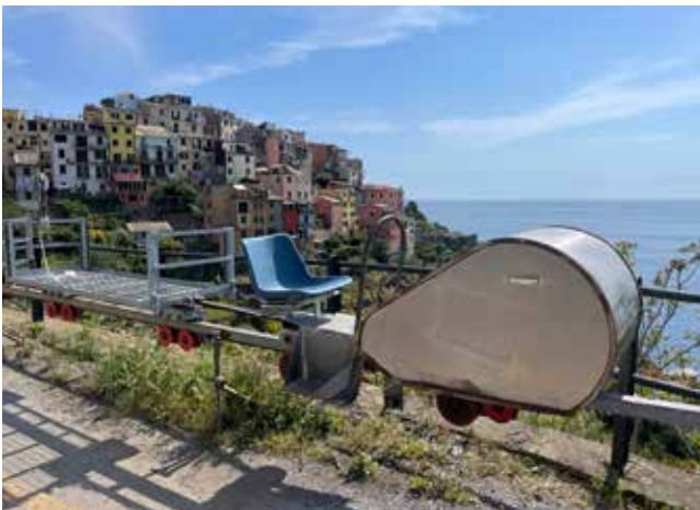
En lille monorail bruges til at fragte dalens frugt- og grøntsagsproduktion op til en asfalteret vej udenfor Corniglia.
