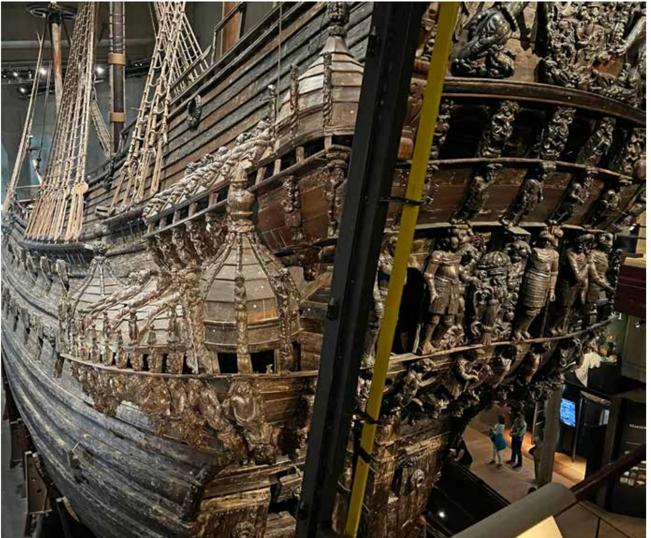
Enormt flotte udskæringer. Der blev ikke sparet på noget. Men det over 20 meter høje agterkastel, som den del hedder, var en af mange årsager til, at skibet kængrede.
